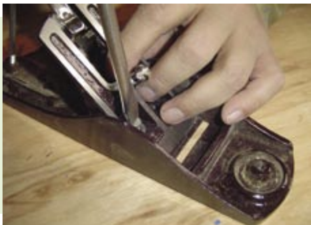
Calibración del mecanismo o "sapo".
